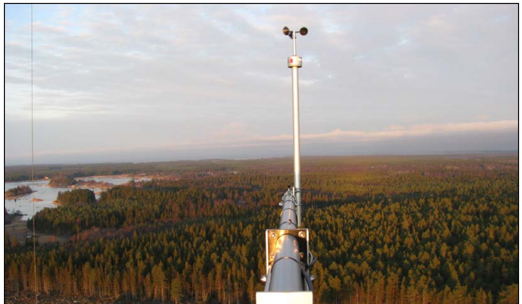
Bild 6.22. I toppen av mätningsmasten på Granö finns bl.a. en anemometer som mäter vindhastigheten.
