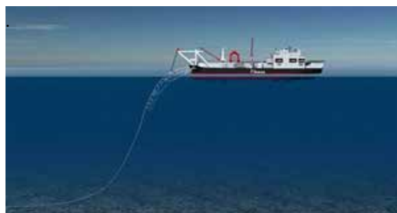
Kuva 2. S-laskumenetelmä dynaamisesti ohjailtavalla putkenlaskaluksella (Allseas.com, 2013)
