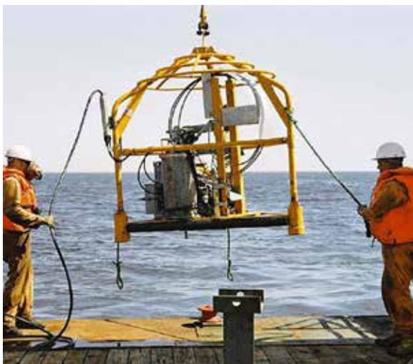
Kuva 8.1. Tyypillinen puristinkairauslautta. Muun näytteenoton lisäksi merenpohjantutkimuksessa käytetään puristinkairausta selvittämään merenpohjan geoteknisiä ominaisuuksia.
