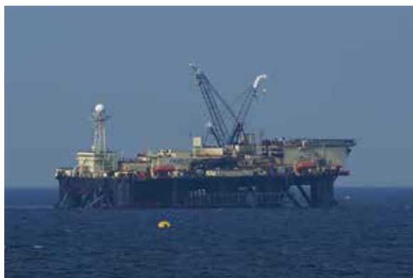
Kuva 1.11. Tyypillisiä putkenlaskualuksia – dynaamisesti asemoitava putkenlaskualus (Solitaire) ja ankkuroitu putkenlaskualus (Castoro Sei)
