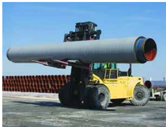
Kuva 3. Putki, jossa on polyetyleenikerros (musta) betonipäällysteen sisäpuolella
