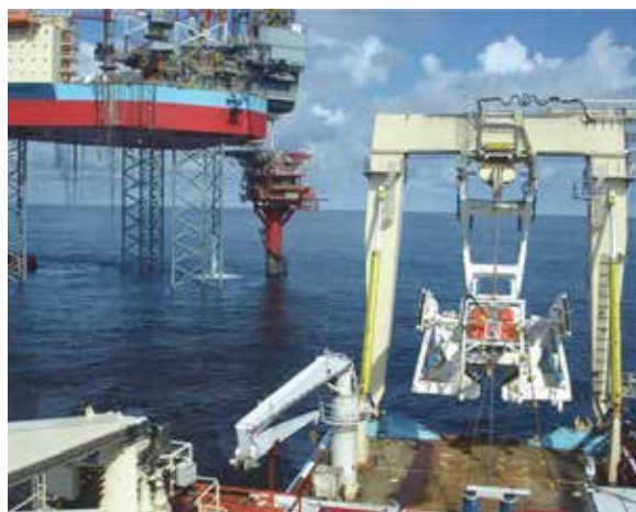
Kuva 1.13. Tyypillisiä putkiauroja - laukaisu kannella olevan A-muotoisen kehyksen avulla
