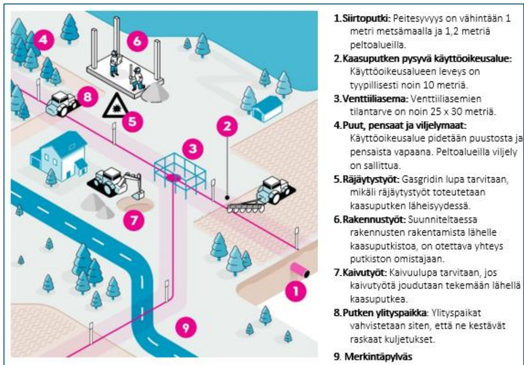
Kuva 2. Vedyn siirtoverkko sekä toiminnot siirtoverkon läheisyydessä (Gasgrid).
