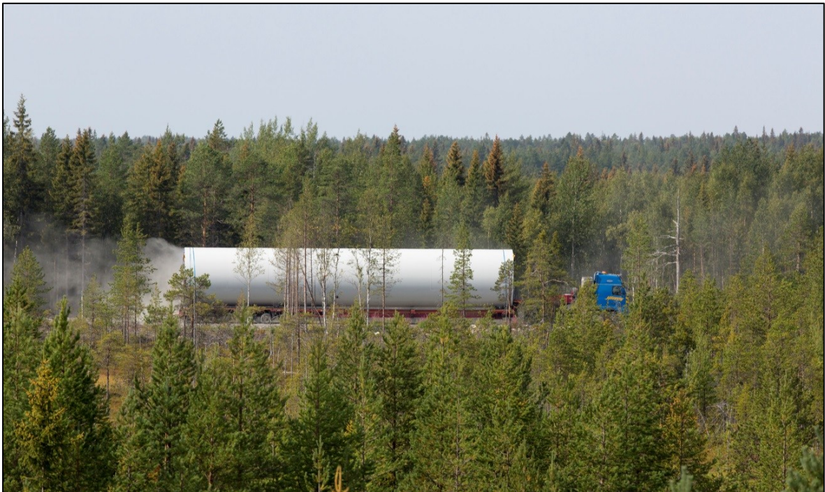
Kuva 4.23 Tuulivoimalan torniosien kuljetusta (FCG Finnish Consulting Group Oy).
