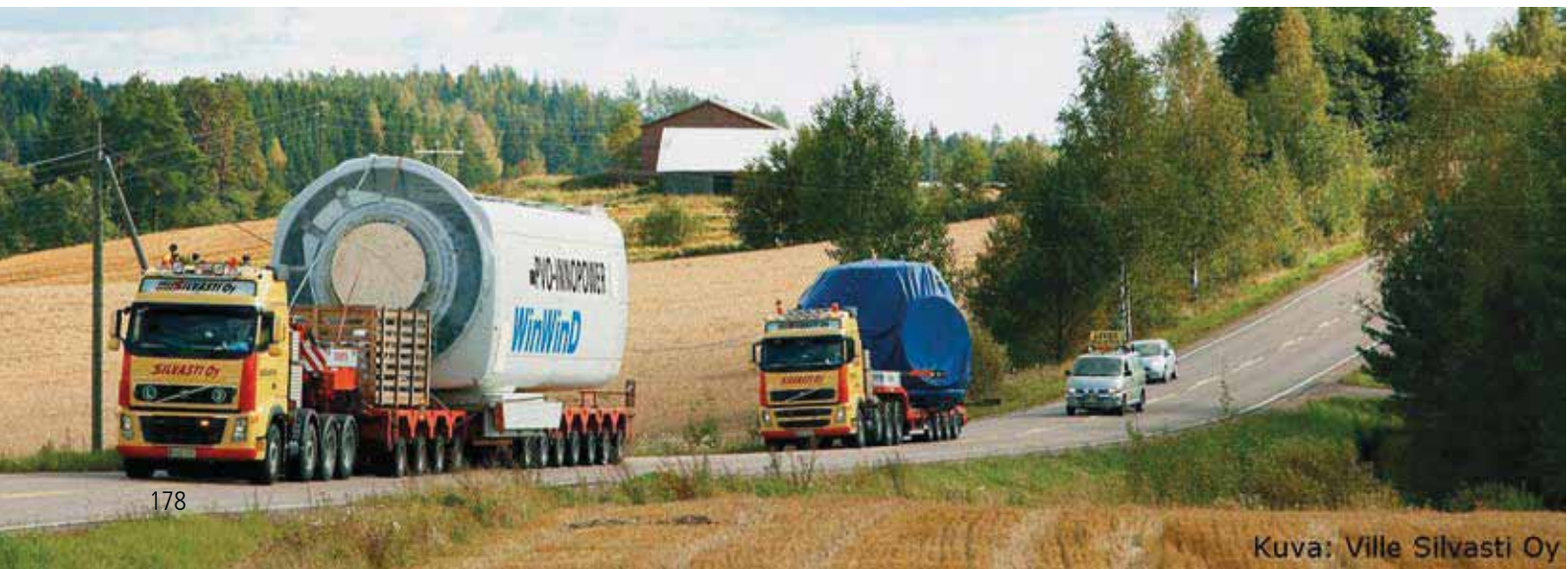
Kuva 19-8. Tuulivoimalan konehuoneen ja navan erikoiskuljetukset.
