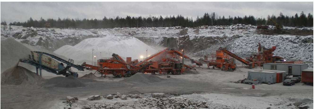
Kuva 14. Murskauslaitoksessa raaka-aine syötetään esimurskaimeen, minkä jälkeen välimurskainten ja seulojen kautta saadaan haluttua murskelajiketta.
