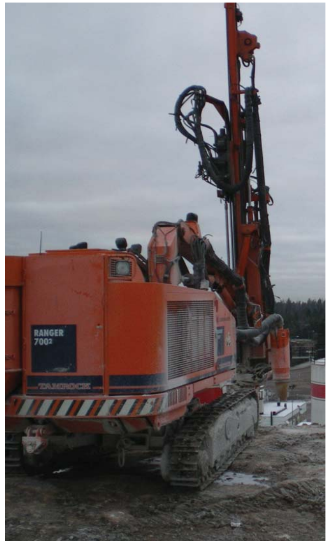
Kuva 13. Kallion porauksessa käytettävä poravaunu. Bild 13. Borravn som används i borrhning av berg.
