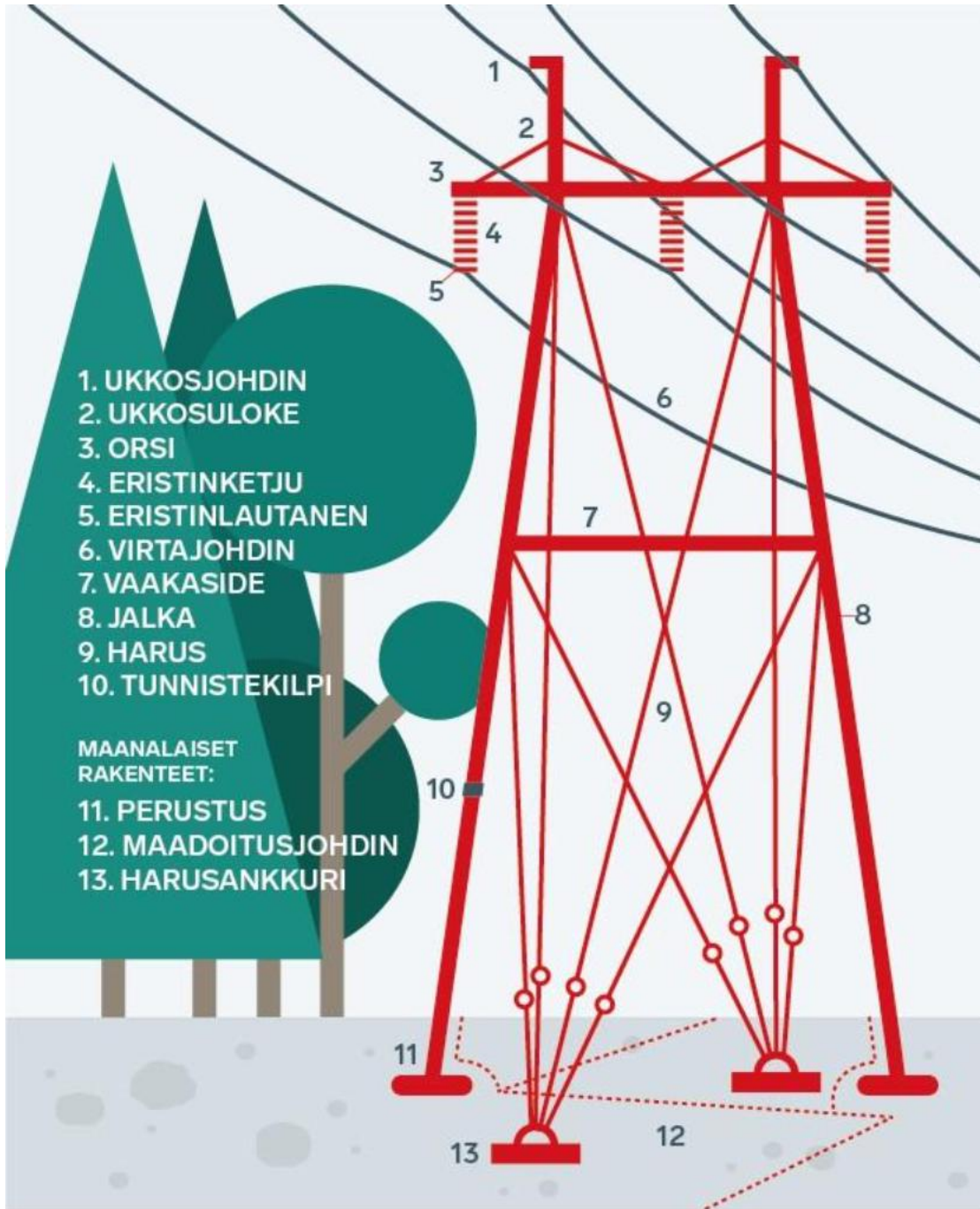
Kuva 1. Voimajohtorakenteen osat. Kuva Fingrid Oy.
