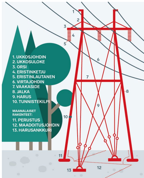
Kuva 4-4. Voimajohdon osat.
