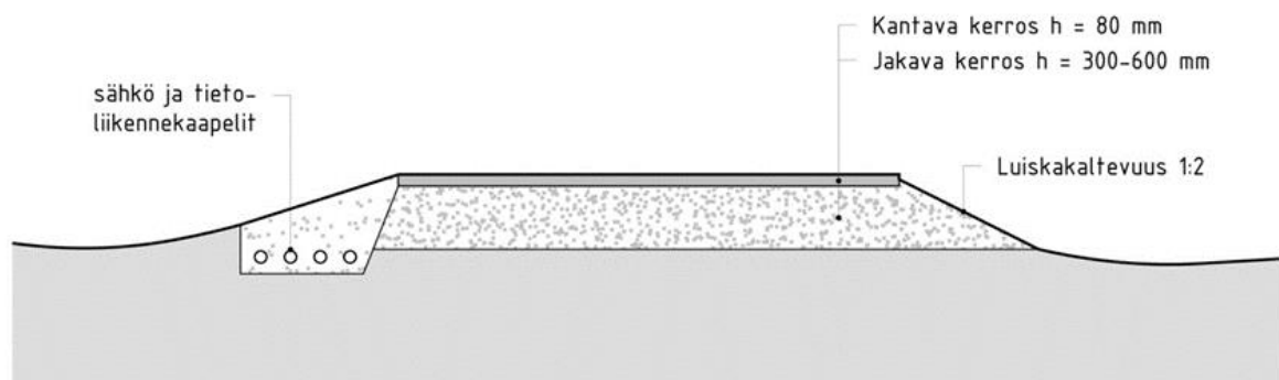
Periaatekuva uuden ja perusparannettavan tien rakenteesta.
