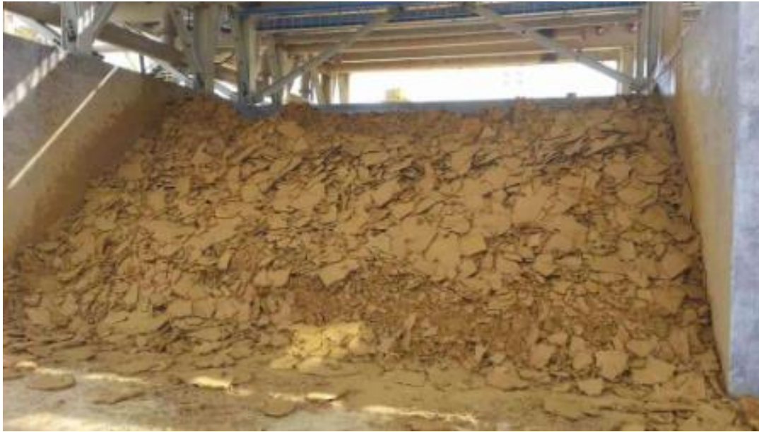
Kuva 4-11. Esimerkki kuivaläjitettävän rikastushiekan välivarastoinnista ennen läjitystä. (McLanahan 2026)
