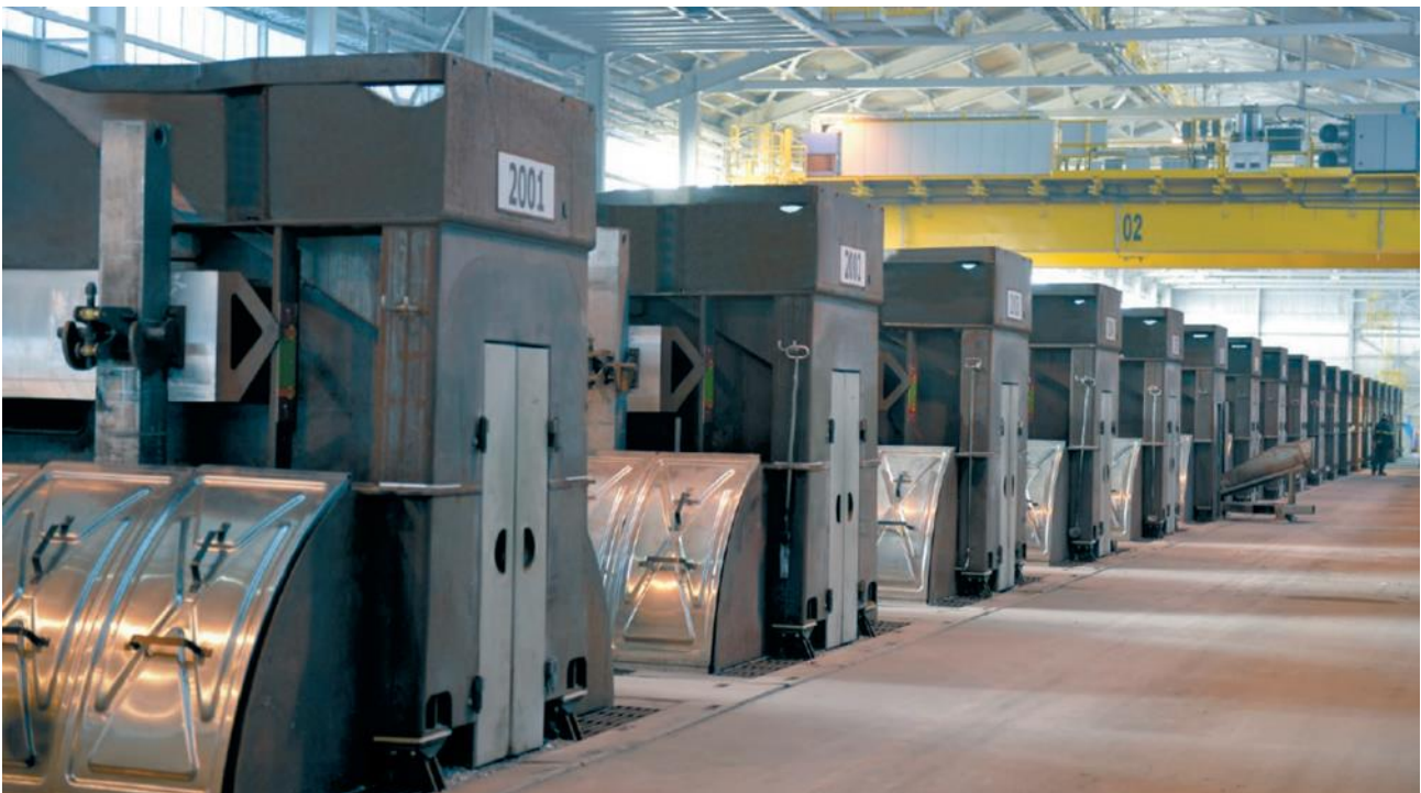
Kuva 7. AP60-kennolinja Rio Tinton Jonquieren tehtaalla Quebecissä Kanadassa.
