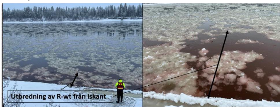
Kuva 7. Kaksi kenttäkokeesta otettua valokuvaa, joihin on merkitty rodamiini WT:n silmämääräinen leviäminen joen leveydeltä. Musta nuoli osoittaa rodamiini WT:n leviämisalueen.
