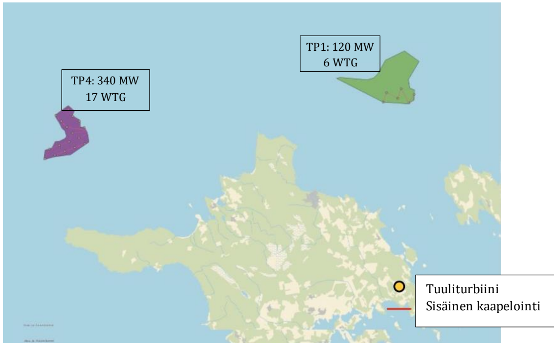
Kuva 3. Myönnetyn vesiluvan perusteella määritetyt mahdolliset tuulivoimapuistoalueet sekä mahdollisten tuuliturbiinien sijainnit (keltaiset pisteet) ja puistojen sisäiset kaapelit (punaiset viivat).
