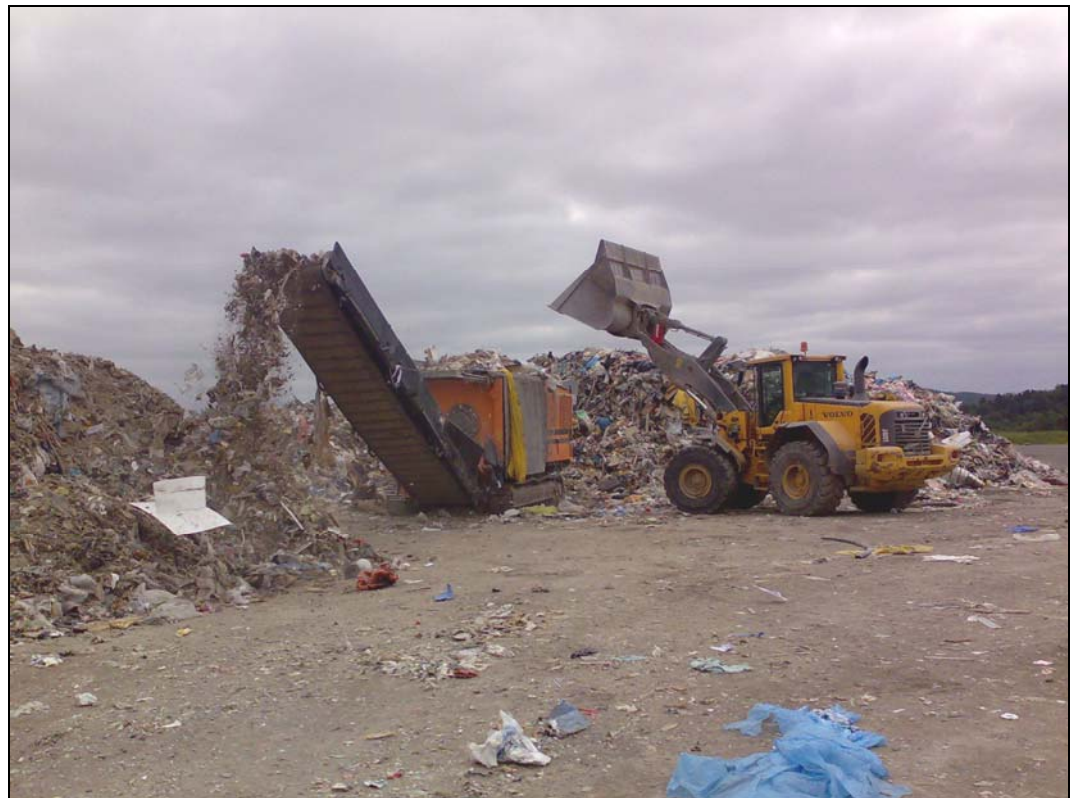
Kuva 6.16. Murskauksesta aiheutuu jonkin verran pölyämistä. Kuva on otettu Göteborgin Renovan jätteenkäsittelykeskuksen alueelta (23.6.2010), jossa yritysjetettä murskattiin ennen paalausta.
