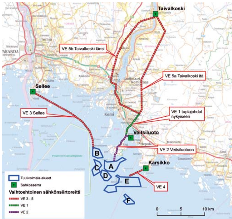
■ Kuva 3-12. YVA:ssa arvioitavat alustavat sähkönsiirron reittivaihtoehdot.
