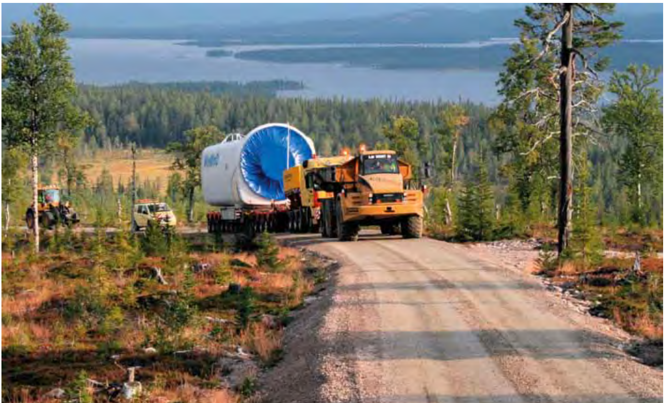
Kuva 5-7. Konehuoneen kuljetus. (Kuva: WinWinD)
