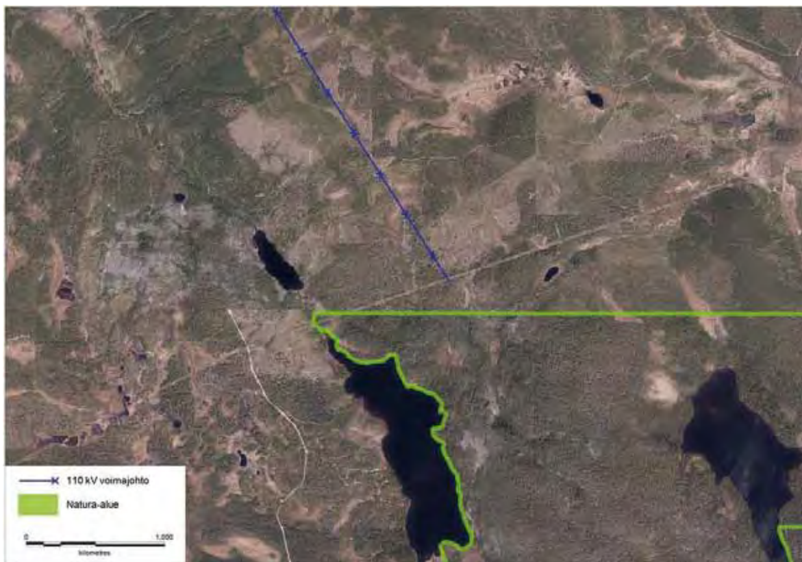
Kuva 4. Ailangantunturin sähkösiirron 110 kV ilmajohto liittyy olemassa olevaan PVO Alueverkot Oy:n 110 kV Jumisko – Pirttikoski -voimajohtoon noin 200 m etäisyydellä Ottavaaran natura-alueen pohjoispuolella.
