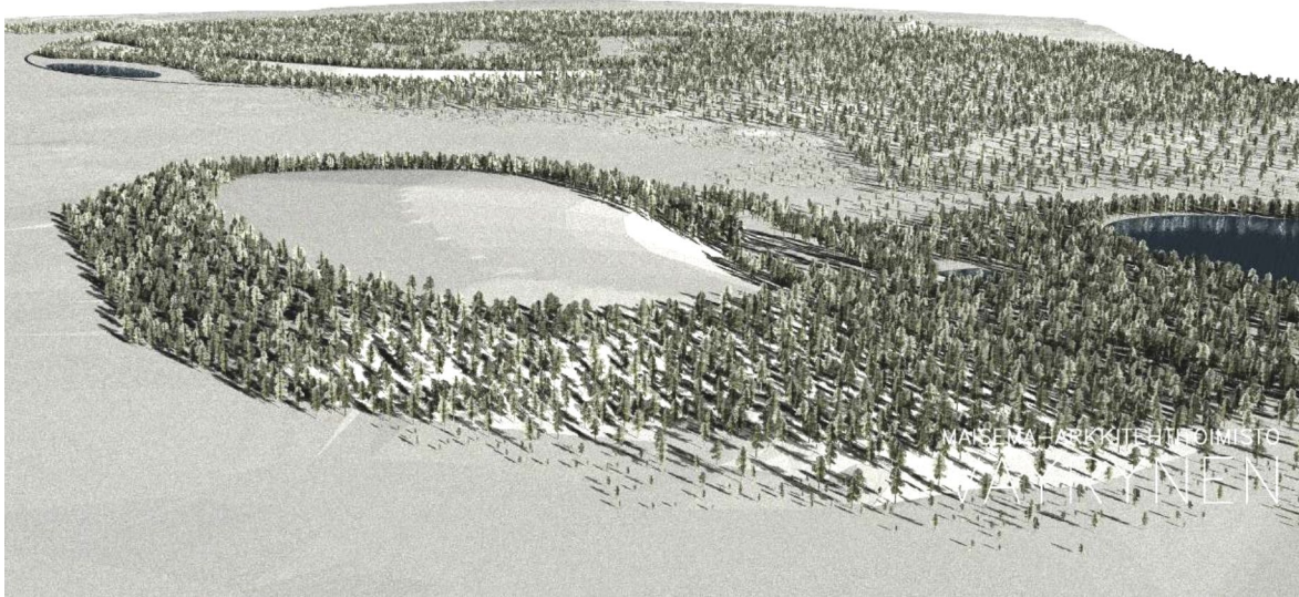
Kuva 55. Hankkeen mukainen sivukiven läjitysalue maisemoituna. Kuvassa muu kaivosalue on 25.6.2008 laaditun maisemoinnin yleissuunnitelman mukainen.
