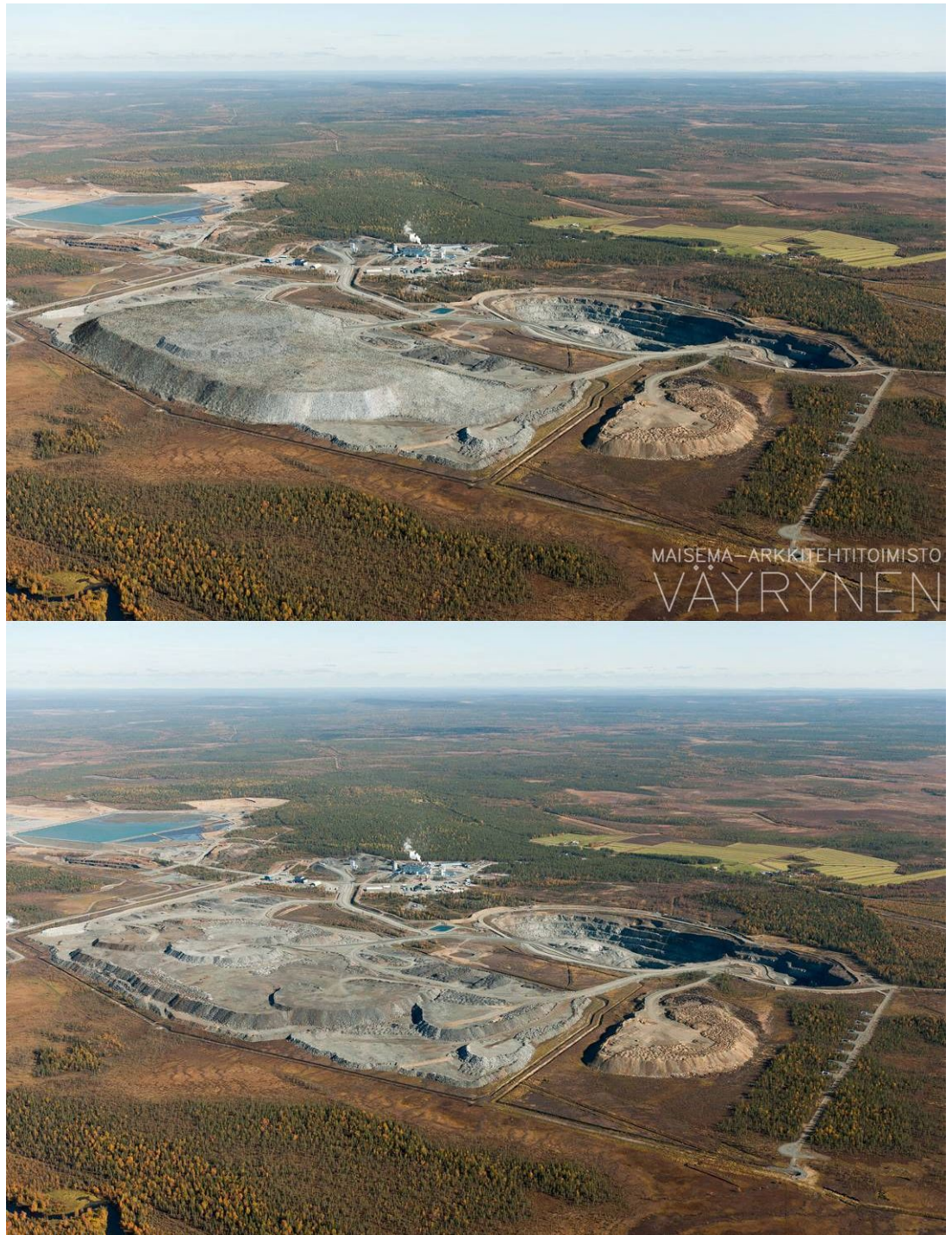
Kuva 54. Ylemmässä kuvassa sivukiven läjitys mallinnettuna. Alemmassa kuvassa nykytilanne. Ilmakuva on otettu 8.9.2010. Kuva on otettu lounaasta lentokoneesta katsottuna kohti läjitysaluetta.
