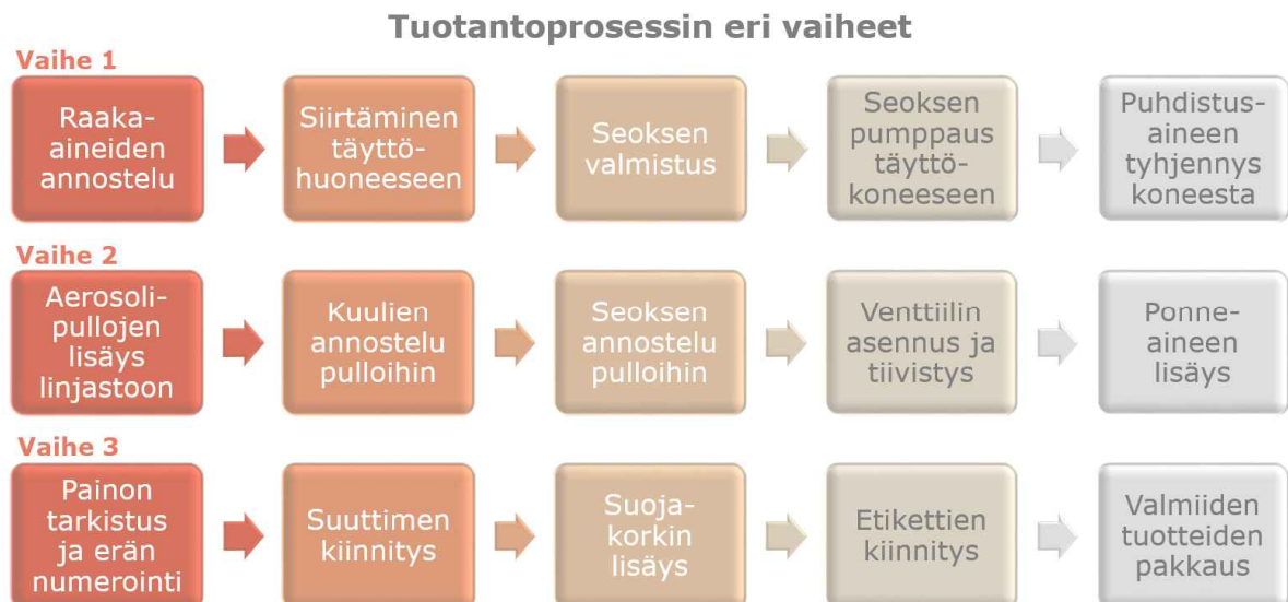
Kuva 2-4. Aerosolitehtaan tuotantoprosessin kuvaus.
