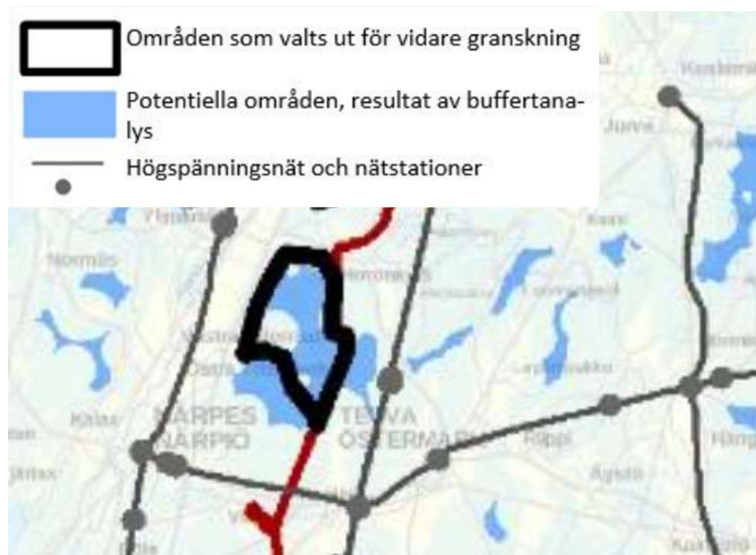
Figur 21. Utdrag ur potentiella områden och områden som valts för fortsatt undersökning (Vindkraftsutredning för Södra Österbotten, Mellersta Österbotten och Österbotten 2021). Enligt resultaten av en buffertanalys sträcker sig ett område med potential för vindkraft fram till Bredåsens projektområde. Ett område som valts för fortsatt undersökning (svart avgränsning) är i sin södra del avgränsat till det vindkraftsområde som anvisas i Österbottens landskapsplan 2040 (projektområdet Bredåsen).
