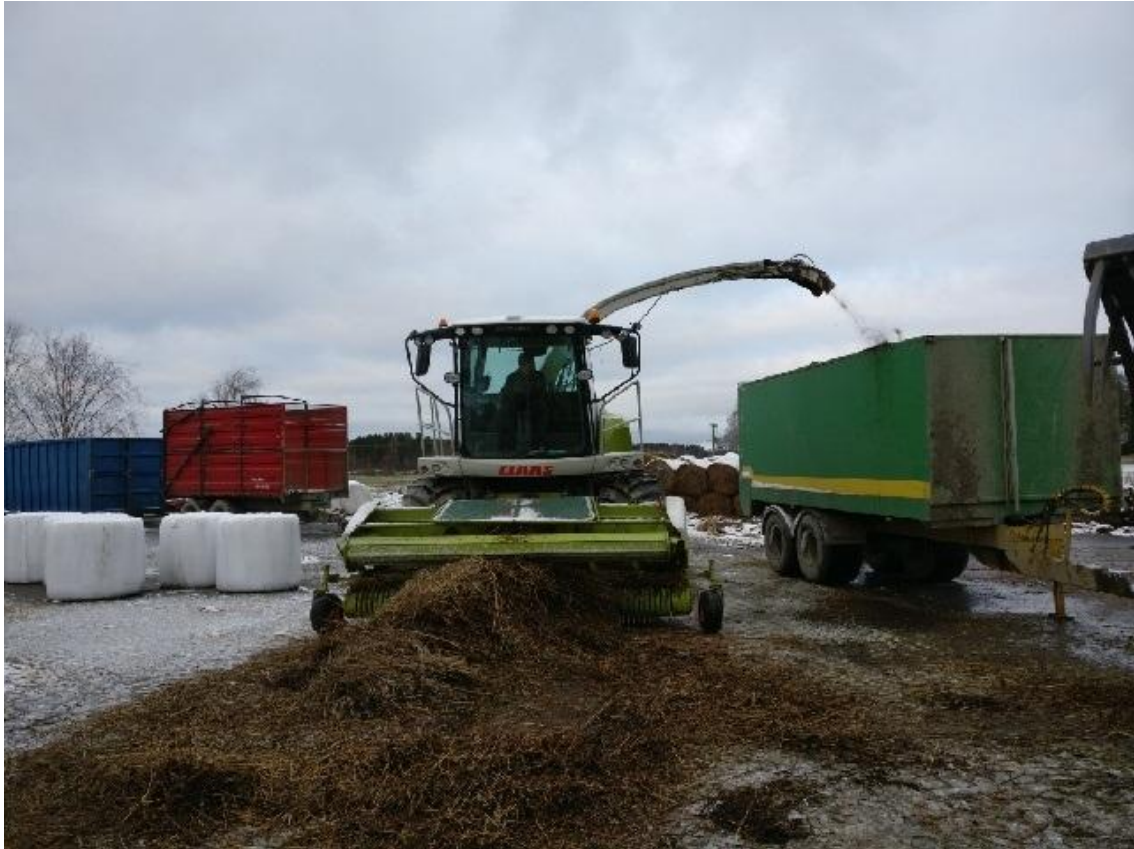
Kuva 6: Ajosilppurilla saatiin hienoa mursketta, mutta se tukkeutui helposti, mikä hidasti työtä.
