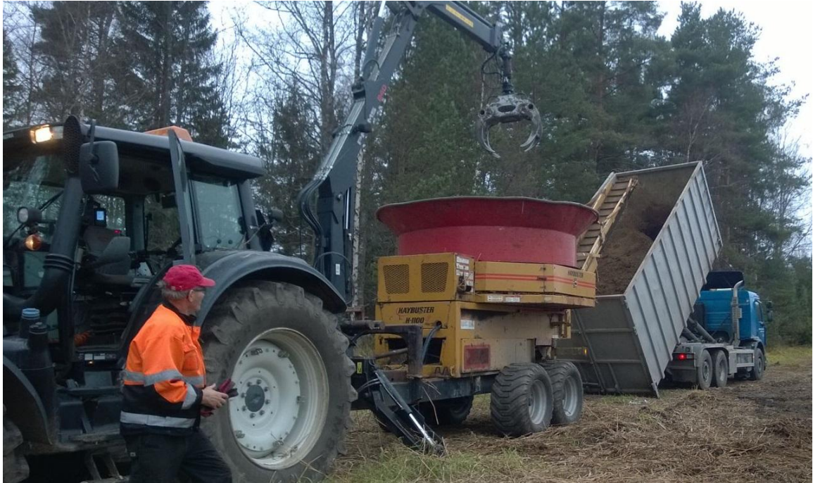
Kuva 5: Haybuster vasaramurskaimella hakettiin syksyllä 2016 järviruokoa kuorma-auton konttiin kuljetettavaksi Kiteen Madon ja Mullan varastolle.
