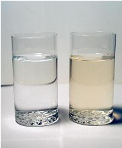
Vesijohtoputkista irronnut rauta on värjänyt veden ruskeaksi. Kuva: Johanna Rissanen
