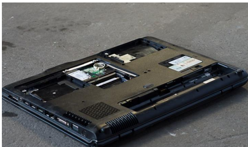
Esimerkki kannettavasta tietokoneesta, joka ei ole toimintakuntoinen: akku, kovalevy ja kuoret puuttuvat.
