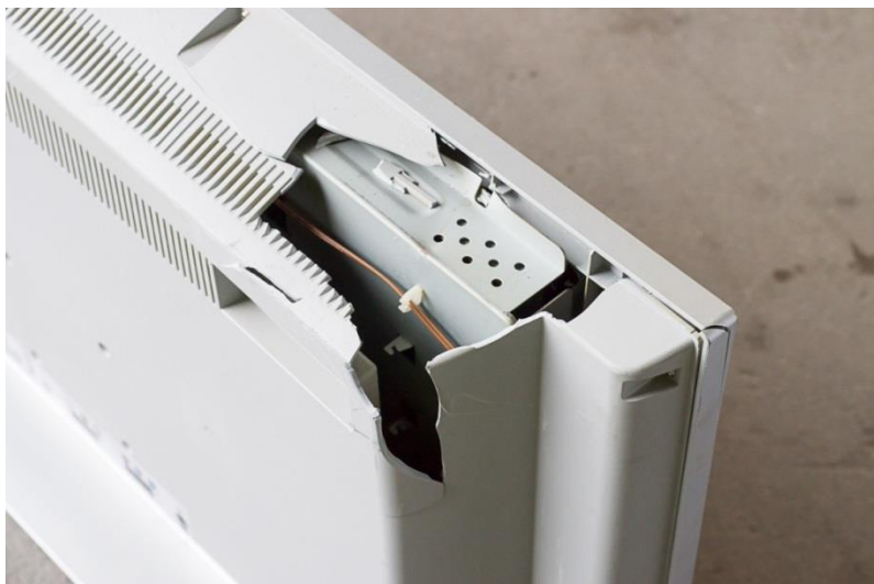
Esimerkki televisiosta, joka ei ole toimintakuntoinen: kotelo pahasti vaurioitunut.
