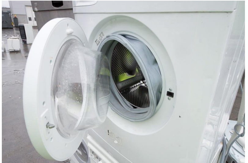
Esimerkki pesukoneesta, joka ei ole toimintakuntoinen: oven tiiviste on vahingoittunut.
