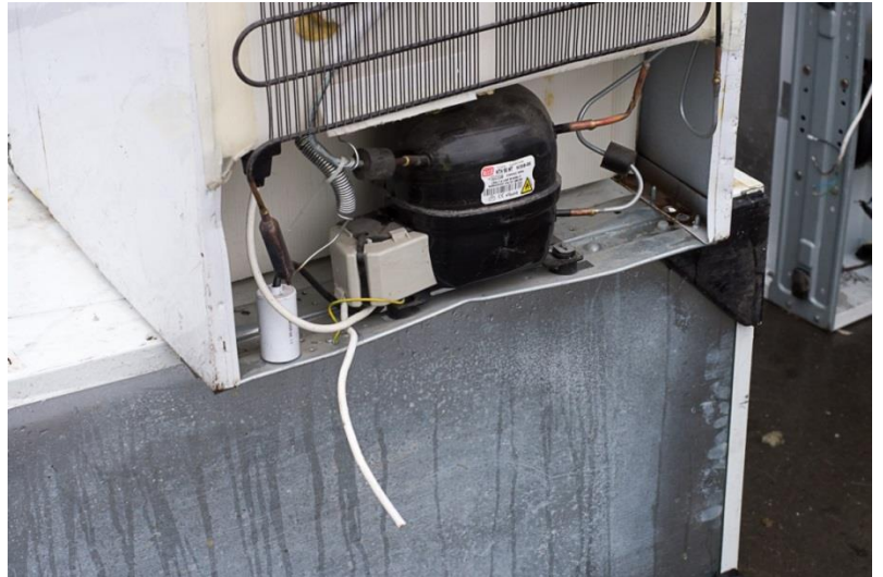
Esimerkki jääkaapista, joka ei ole toimintakuntoinen: virtapistoke puuttuu.
