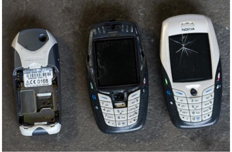
Esimerkkejä matkapuhelimista, jotka eivät ole toimintakuntoisia: akku ja kotelo puuttuvat (vasemmalla), näppäimistö on vahingoittunut (keskellä) ja näyttö on rikki (oikealla).
