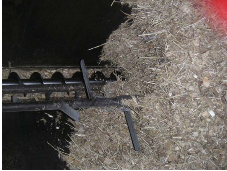
Kuva 11. Hake-järviruokoseoksen holvatessa repijöiden päälle.
