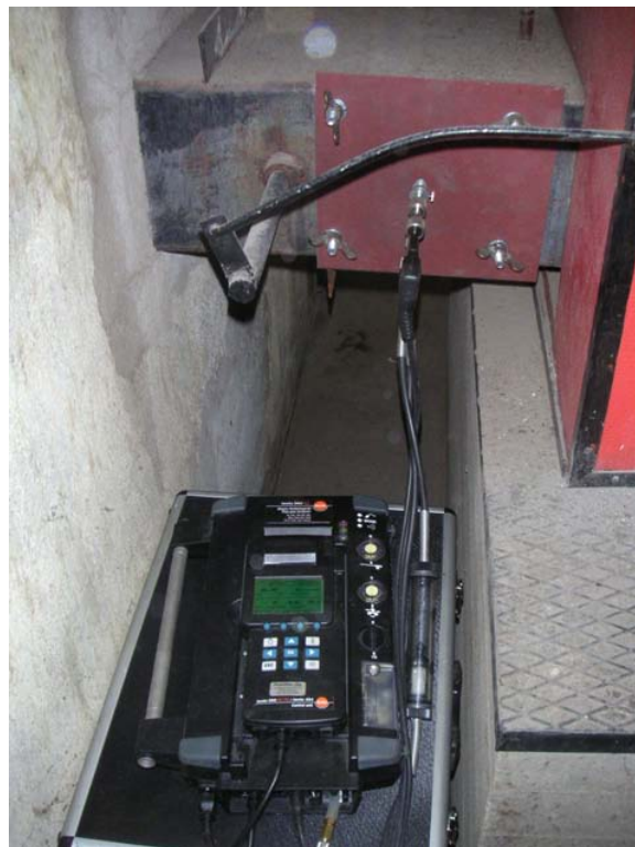
Kuva 10. Testo-savukaasuanalysointilaitteet sekä mittapään läpivienti.
