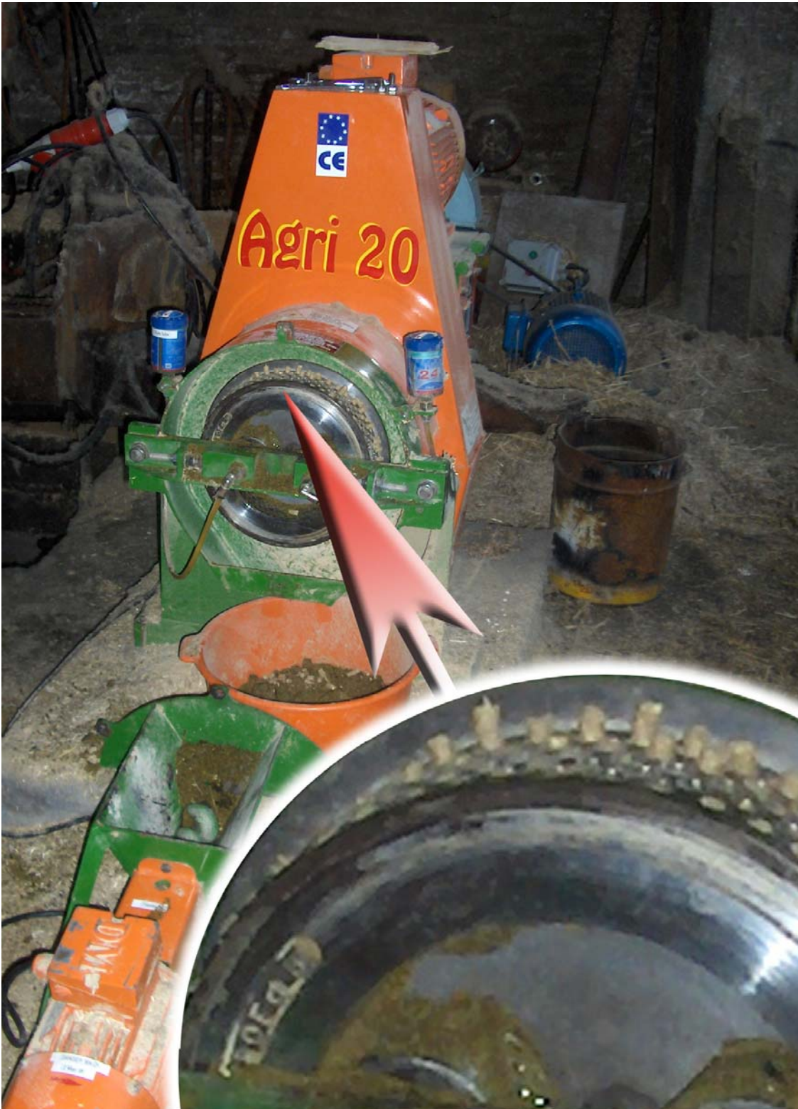
Kuva: Pellettikone sivulta syöttölaite edessä maassa. Etualalla suurennos matriisista.
