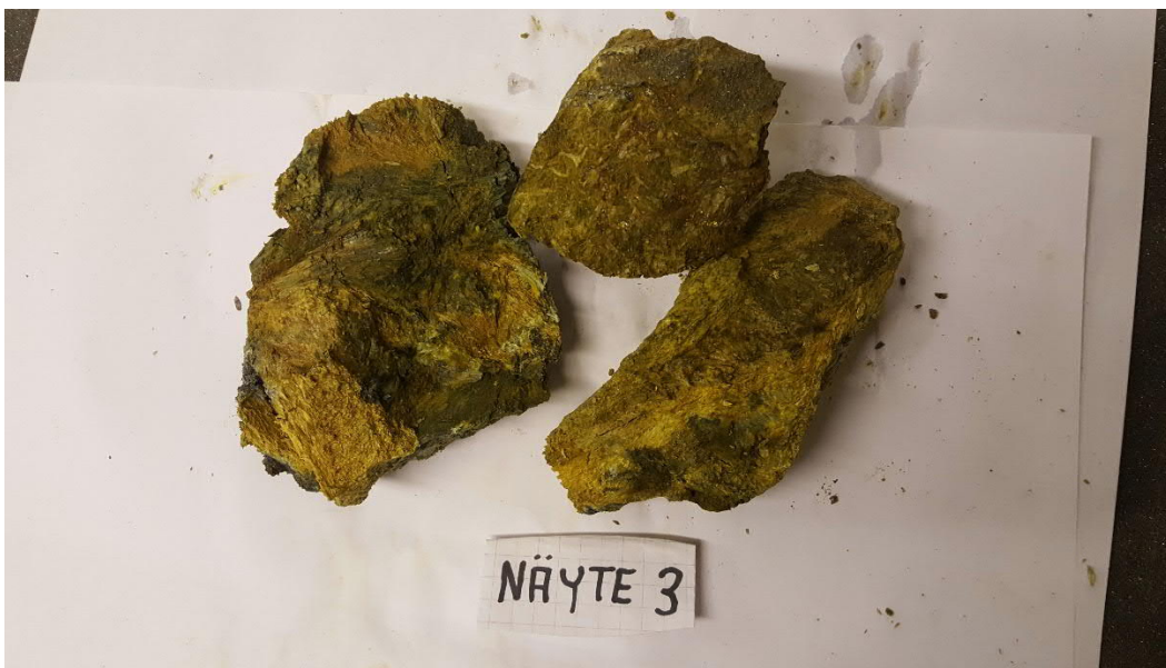
Kuva 4 Näyte 3 sisälsi analyysin mukaan 22,6 paino-% tremoliitti-aktinoliittia
