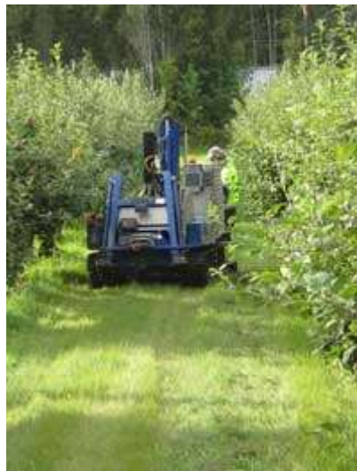
Painokairauksilla selvitettiin maaperän paksuutta ja koostumusta. Kuvat: Maria Mäkinen
