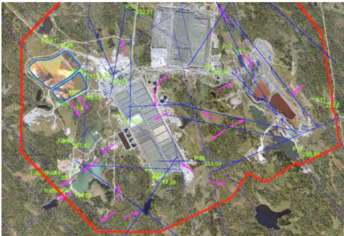
Kuva 12-3. Vuoden 2015 ilmakuvassa ruhjevöyhykkeet (sininen), kalliopohjavedenpinnat 2015 ja arvioidut virtausnuolet (magenta) (Poyry Finland Oy 2017).
