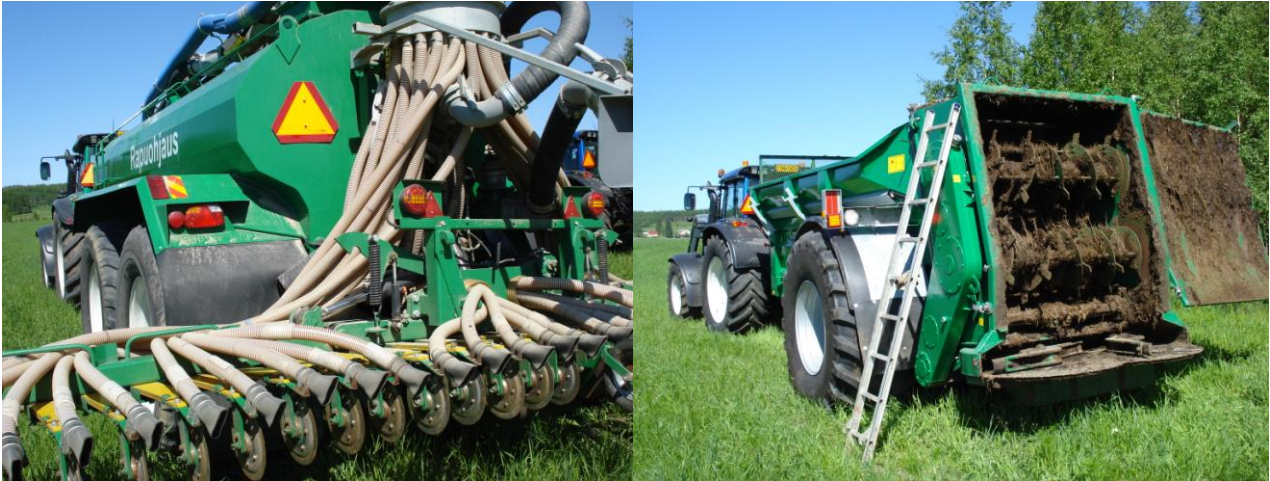
Agronic 14 m 3 pumppukuormainvaunu rapuohjauksella ja Agronic -multaimella sekä Samson Flex 16 kuivalannantarkkuuslevitin.
