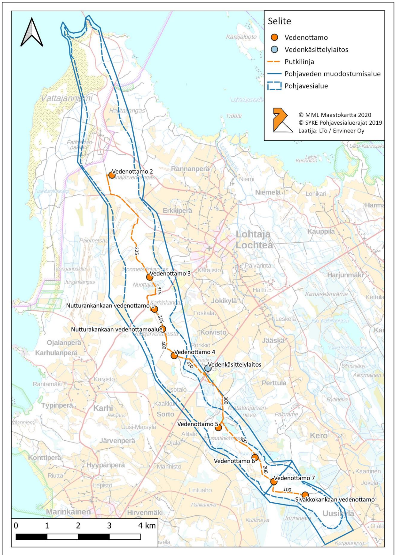
Kuva 3. Karhinkankaan ja Sivakkokankaan pohjavesialueet, Nutturakankaan ja Sivakkokankaan nykyiset vedenottamot, suunnitellut vedenottamot, vedenkäsittelylaitos ja putkilinjat.
