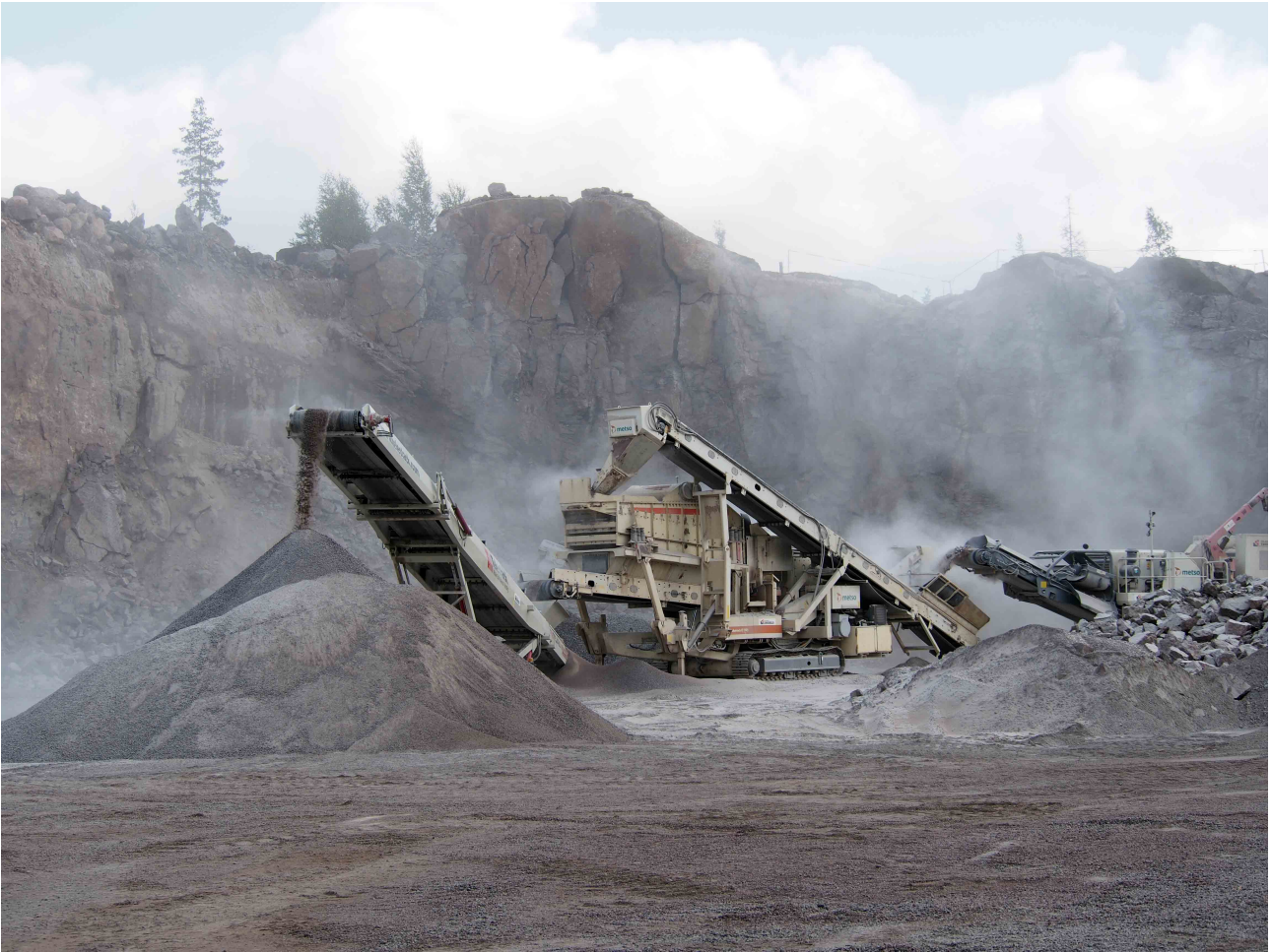
Kuva 19. Kiviaineksen murskausta ja seulontaa hankealueella kesällä 2017.
