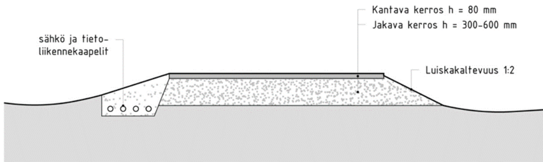
Periaatekuva uuden ja perusparannettavan tien rakenteesta.
