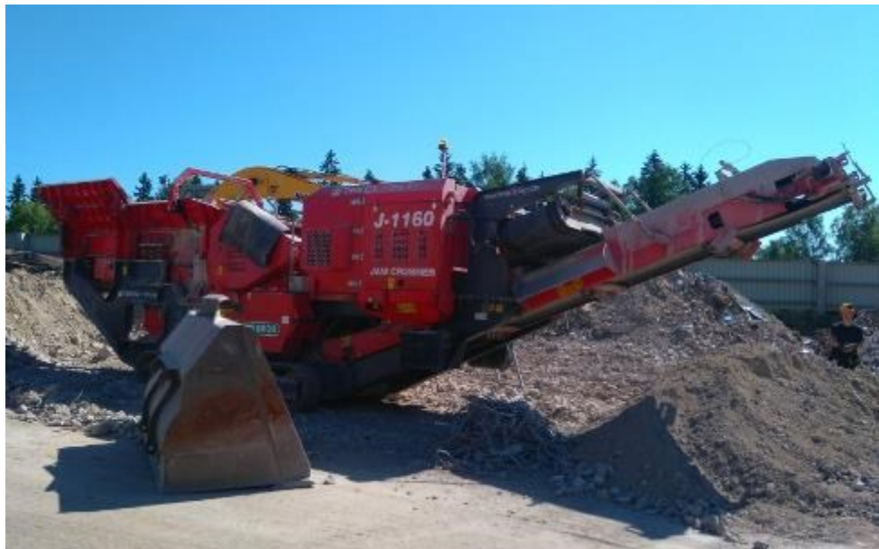
Kuva 13. Betoni- ja tiilijätteen murskain.
