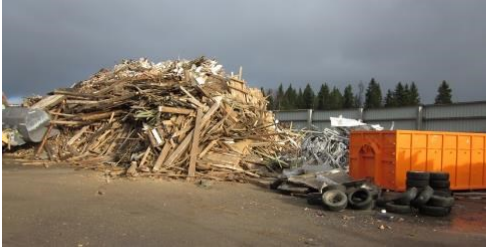
Kuva 9. Rakennuspuujäte vastaanotetaan varastokentälle ja käsitellään hallissa.
