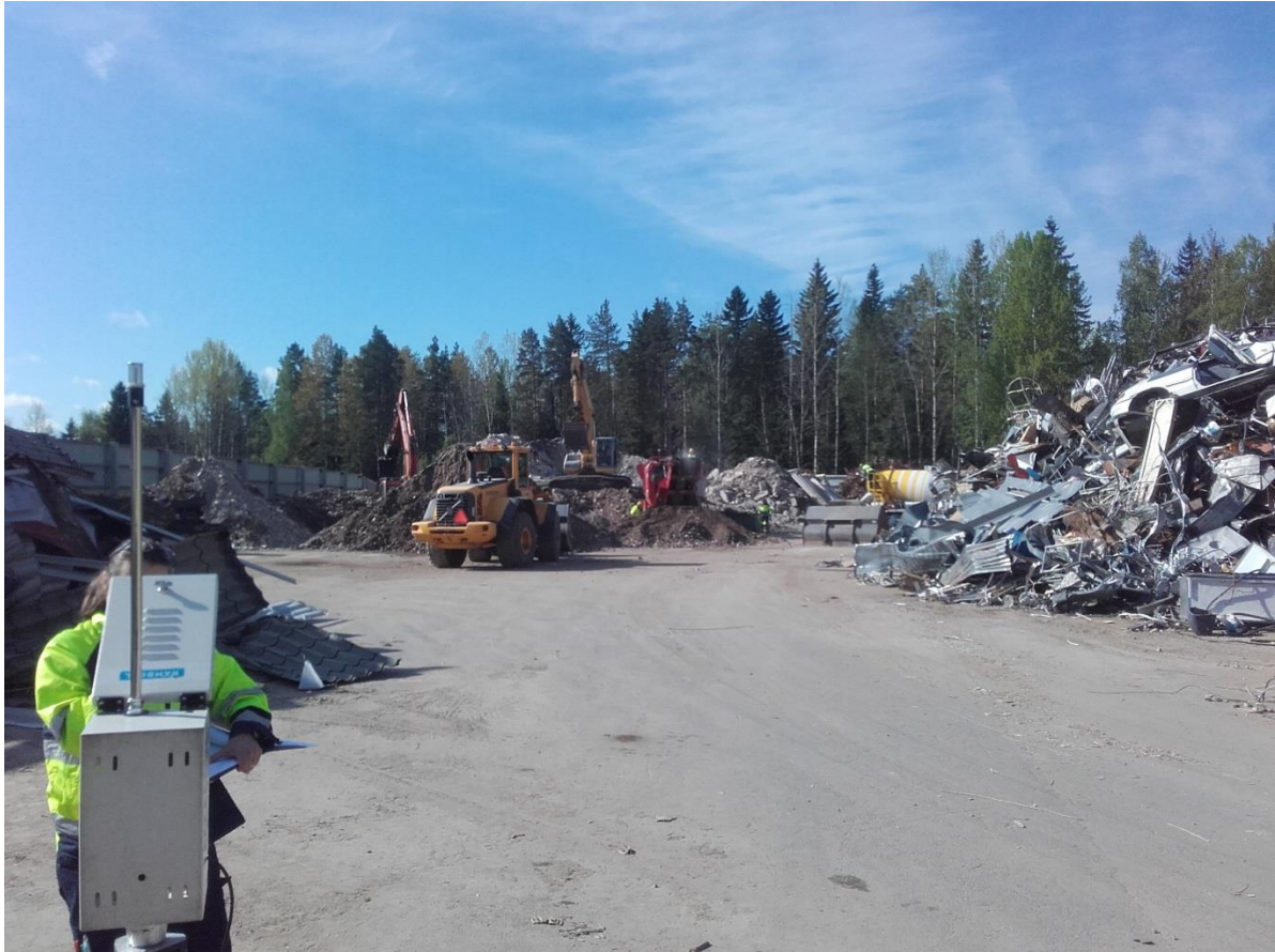
Kuva 3. Hajapäästömittaukset. Betonin murskauksen ja käsittelyn aiheuttamaa pölyä kulkeutuu tuulen mukana mittauspisteeseen. Mitatun pitoisuuden ja leviämismallinnuksen avulla määritetään toiminnan hajapölypäästökerroin (g/m 2 s).
