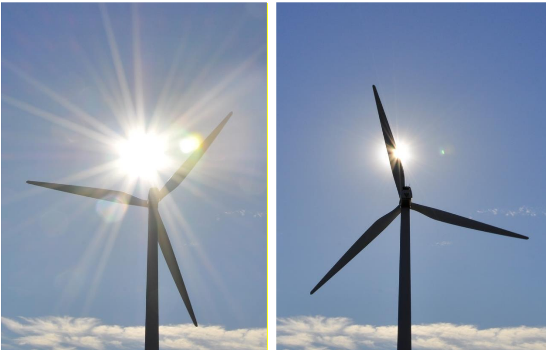
Kuva 17.18. Tuulivoimaloiden lavat aiheuttavat pyöriessään vilkkumista ja varjon välkkymistä aurinkoisella säällä.
