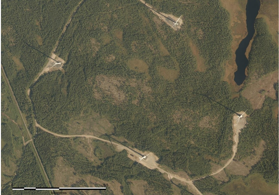
Kuva 4.1. Ilmakuvasa näkyy toiminnassa olevia tuulivoimaloita. Tuulivoimaloita varten on rakennettu huoltotiet ja nostokentät. Tuulivoimaloiden ympäristössä ja välialueilla aikaisempi maankäyttö on säilynyt ennallaan. Kuva ei ole Paholammin hankkeelta.
