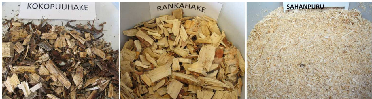
Kuva 10. Puupolttoainejakeita jalostettuna leijukattilalaitoksen käyttöön soveltuvaksi. Kuvat Oulun Energia.
