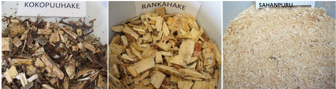
Kuva 8. Puupolttoainejakeita jalostettuna leijukattilalaitoksen käyttöön soveltuvaksi. Kuvat Oulun Energia.
