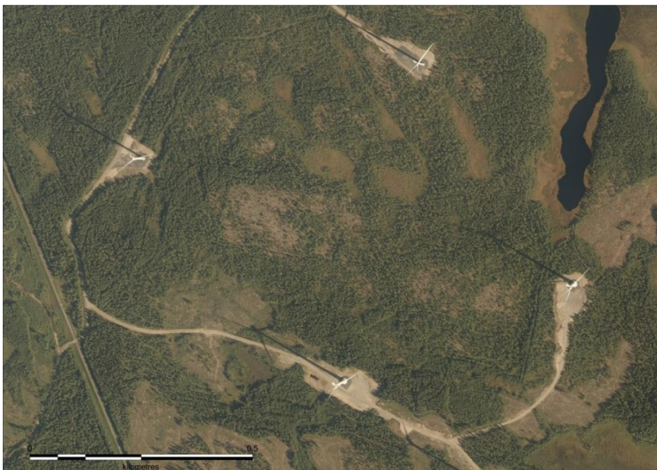
Kuva 5-1. Ilmakuvassa näkyy toiminnassa olevia tuulivoimaloita. Tuulivoimaloita varten on rakennettu huoltotiet ja nostokentät. Tuulivoimaloiden ympäristössä ja välialueilla aikaisempi maankäyttö on säilynyt ennallaan (Maanmittauslaitos). Kuva ei ole Lylyharjun alueelta.
