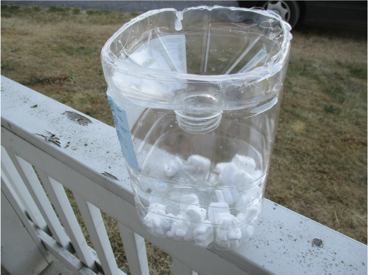
Kuva 2. Pyydys sukeltajakuoriaisia varten: vesikanisterista (5 l) on leikattu kartiomainen pääty pois ja liimattu se kuumaliimalla takaisin ”suppiloksi”. Sisällä on styroxpaloja, joiden avulla pyydys jää kellumaan. Syötiksi laitetaan kalaa, matoja, lihanpaloja, maksaa, koiranruokaa tai rapusyöttiä. Pyydys heitetään rannalta veteen. Ankkurina on kivi ja vetoköyden pää sidotaan rantakasviin kiinni.
