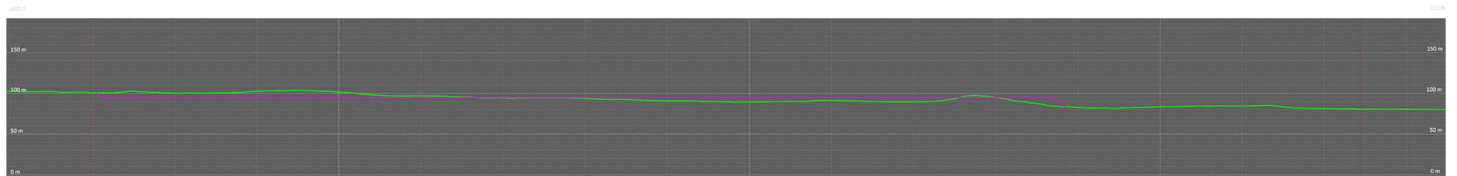
Kuva 1.2-Leikkaus A – A. Vihreällä on merkitty alkuperäinen maanpinnan taso ja violetilla vaihtoehdon 4 mukainen maanpinnan taso.
