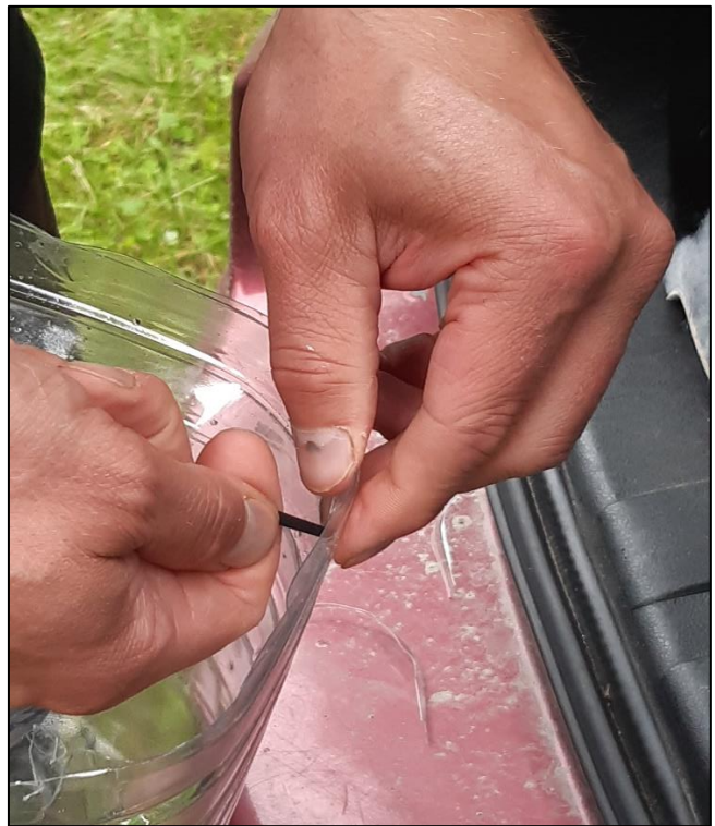
Kuva 5. Suppiloksi käännetyn suuosan kiinnitys nippusiteellä.
