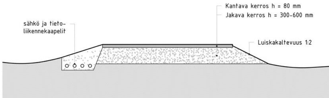
Periaatekuva uuden ja perusparannettavan tien rakenteesta.
