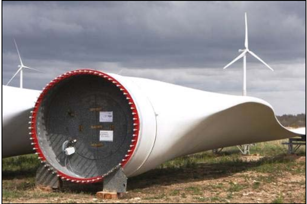
Kuva 4.4. Esimerkki 3 MW tuulivoimalaitoksesta (taustalla) ja sen lavasta (WinWinD).
