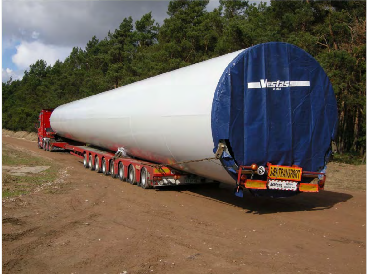
Kuva 3.43. Tornin osan kuljetus (Kuva: Erik Trast / CPC Finland Oy).
