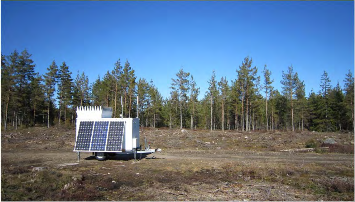
Kuva 3.6. Lappfjärdin ja Lakiakankaan yhteiset tuulimittaukset on käynnistetty tuulivoimapuistalueella kaikuluotaavalla Sodar-laitteistolla syksyllä 2011 (Kuva: Hans Vadbäck / FCG).
