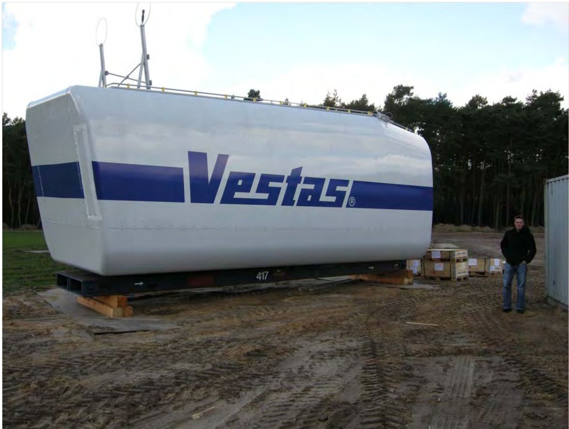
Kuva 3.9. Esimerkki tuulivoimalan (turbiinimalli: Vestas) konehuoneesta eli nasellista (Kuva: Erik Trast / CPC Finland Oy).
