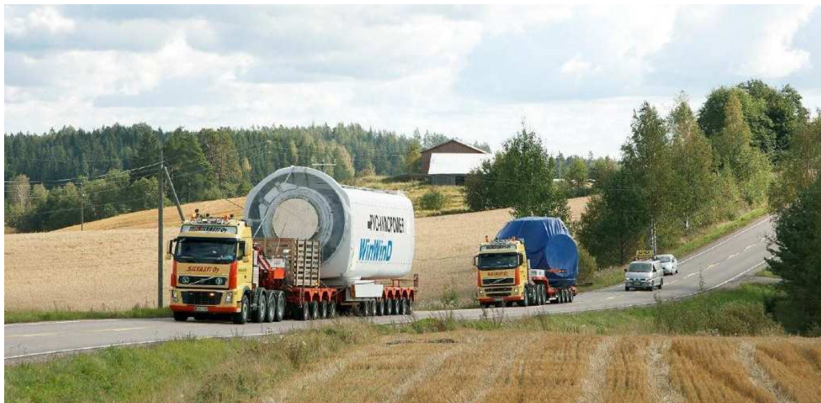
Kuva 129. Tuulivoimalan konehuoneen ja navan erikoiskuljetukset (Ville Silvasti Oy).
