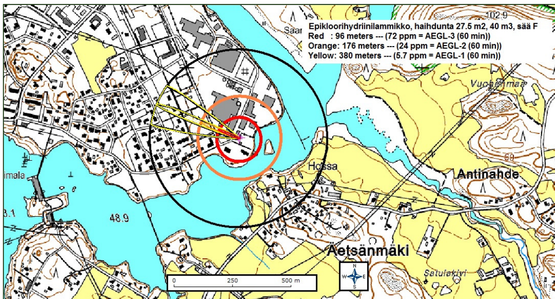
Kuva 11. Epikloorihydriinisäiliön vuoto varoaltaaseen. Epikloorihydriinin haihtuminen, 60 minuutin AEGL-arvojen esiintymisetaisyydet säättyypissä F (=pahin tilanne). AEGL-2 (60 min) pitoisuusalue ulottuu 176 m etäisyydelle varoaltaasta (oranssi ympyrä). (Kuvassa keltainen AEGL-1 on vahvistettu mustalla erottumisen takia)
