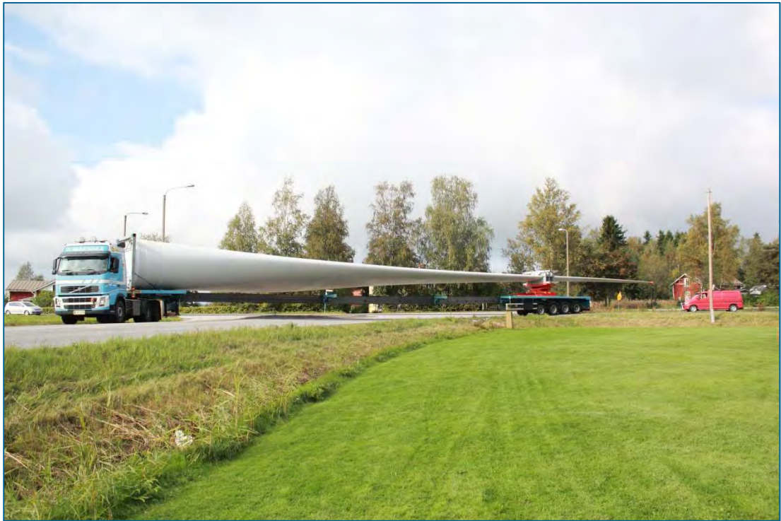
Kuva 5.19 Tuulivoimalan lavan erikoiskuljetus (Kuva: Hans Vadbäck, FCG)
